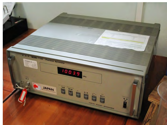
JICA の支援で 1996 年に導入された電気式気圧計
