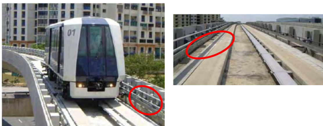
図 3-14 AGT の電車線イメージ
