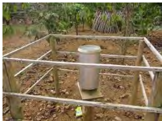
図 3.3-2 Nong Mek の水位計・雨量観測計
