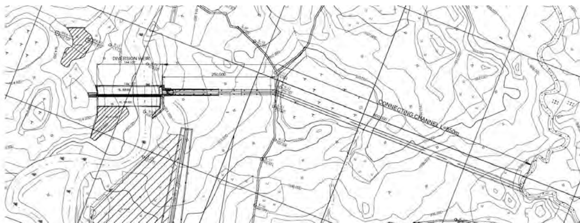
図 5-1 引水堰と引水路
