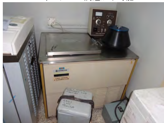
写真 2-20 遠心機 老朽化により故障
