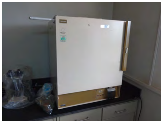
写真 2-24 CO2 インキュベーター 耐用年数が過ぎており更新が必要
