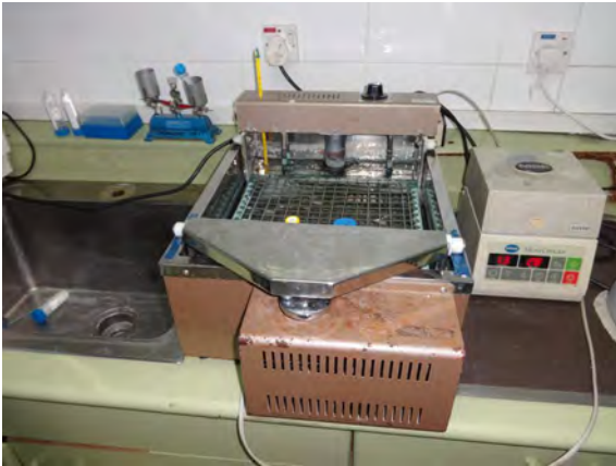
写真 2-31 振とう恒温槽 老朽化が著しい
