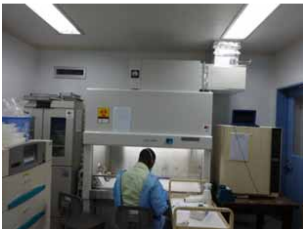
BSL-3 実験室（細菌学）の安全キャビネット： 今後も同既存実験室で引き続き使用される予定
