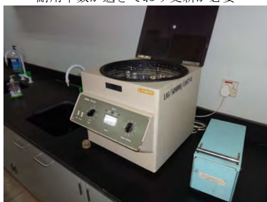
写真 2-26 遠心機 老朽化しており更新が必要
