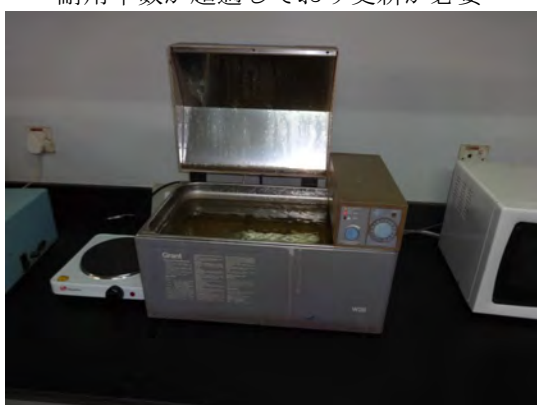
写真 2-25 恒温槽 老朽化が著しい
