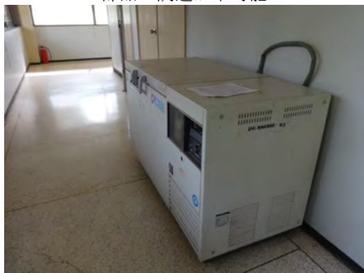
写真 2-19 超低温冷凍庫 老朽化により正常に稼働しない
