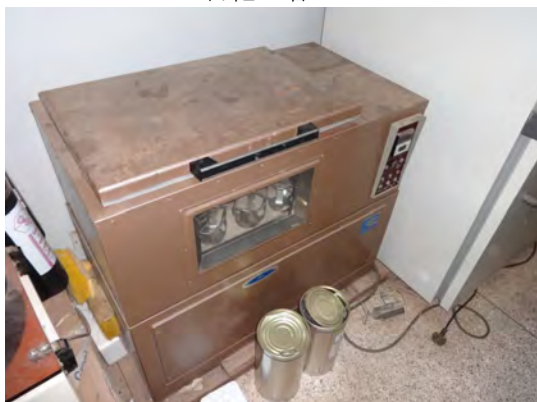
写真 2-27 振とう恒温槽 老朽化により故障
