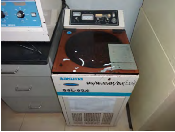
写真 2-29 冷却遠心機 老朽化が著しく更新が必要
