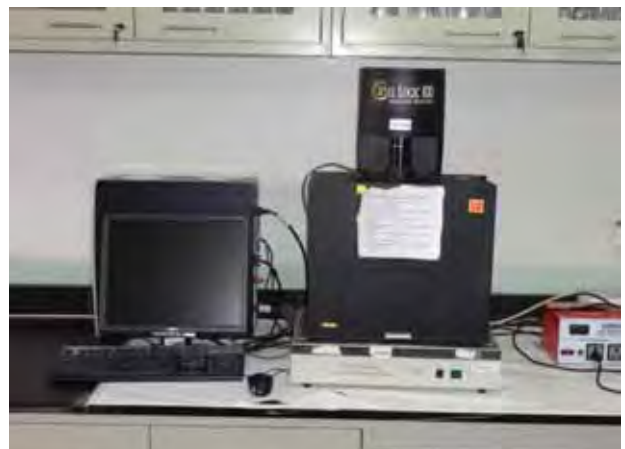
ウイルス学部門の電気泳動ゲル撮影装置： 老朽化により正常に稼動しない
