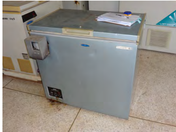
写真 2-32 フリーザー 老朽化が著しく頻繁に故障
