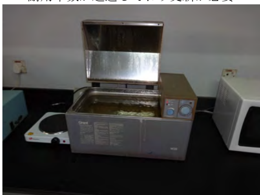
写真 2-25 恒温槽 老朽化が著しい
