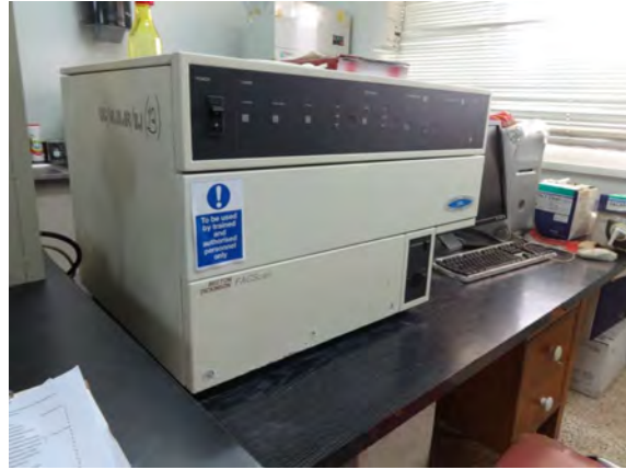
写真 2-30 フローサイトメトリー 耐用年数を過ぎており更新が必要
