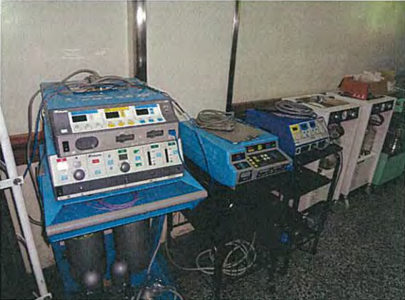
2003年に我が国の無償事業で調達された電気メス（左側）で現在も稼働している。消耗部品の調達が困難。
