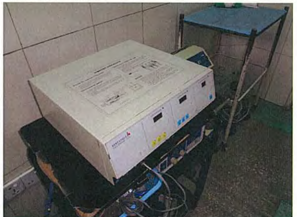
1990年代に保健省が購入された手術室の電気メスで現在も稼働が機能低下が著しい。
