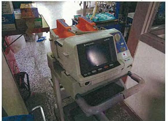
2003年に我が国の無償事業で調達されたICU部門の除細動器。充電機能が故障、修理部品の調達不能。
