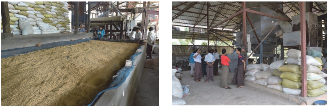
写真 1-22 平面型乾燥機及び縦型乾燥機、縦型乾燥機の手前の部分が籾殻燃焼機
