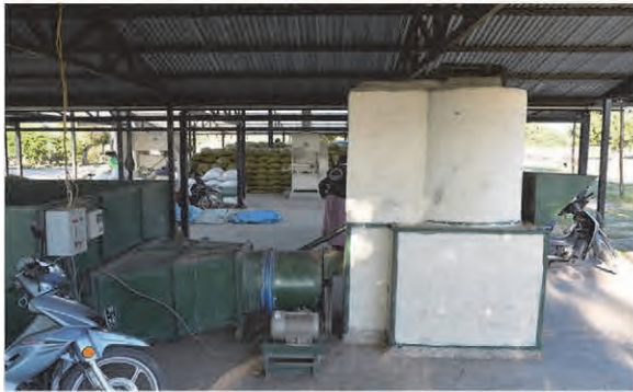
平面型乾燥設備の籾殻燃焼炉+送風部
