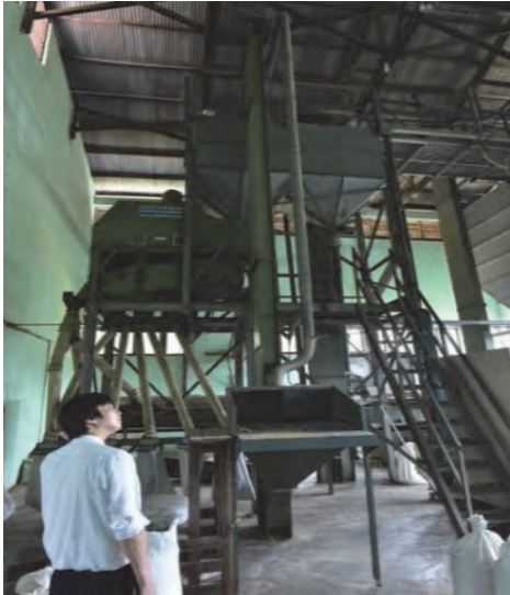
出典：JICA 調査団モウピイにて撮影 写真 1-26 精選施設荷受けホッパー+シードクリーナー（左）、貯蔵瓶+消毒機（右）
