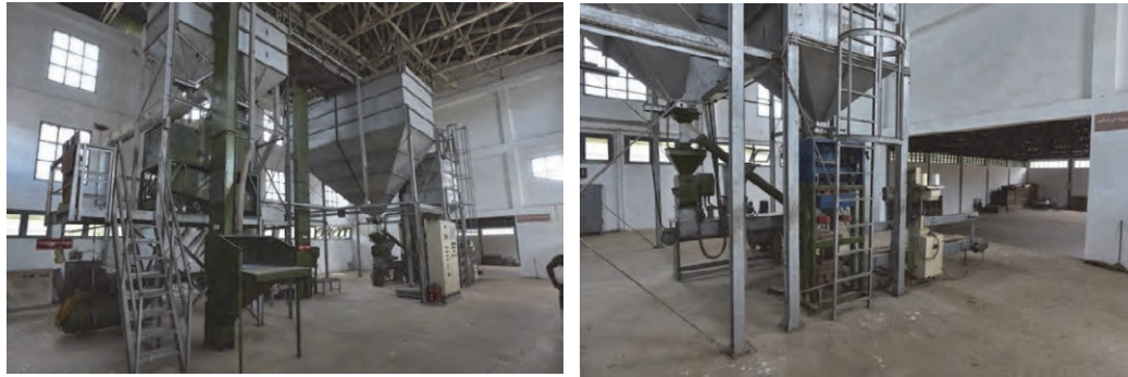
写真 1-29：ミンガラドンの種子精選施設荷受けホッパー・シードクリーナー部（左） および消毒・計量部（右）
