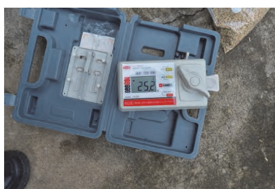
写真 1-20 電気抵抗式水分計での測定状況
