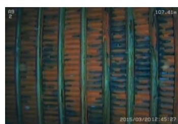
写真-2 井戸カメラによる改修効果の確認実証（A9-II井）
