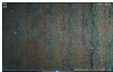
写真-2 井戸カメラによる改修効果の確認実証（A9-II井）
