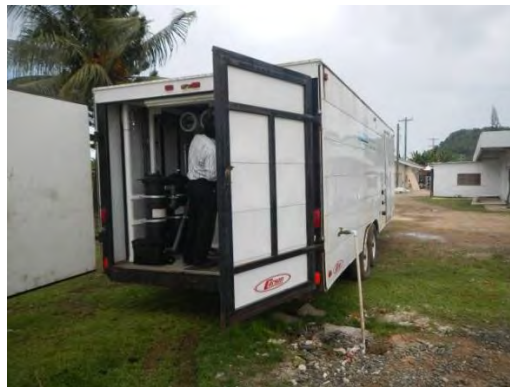
図 3.7 CPUC に寄付されたトレーラー式海水淡水化装置 (故障中)
