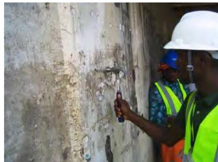
図 3-4 打音検査実務実施状況
