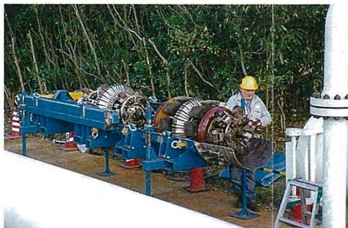
図 2.4-24 インテリジェントピグによる健全性確認 (例)
