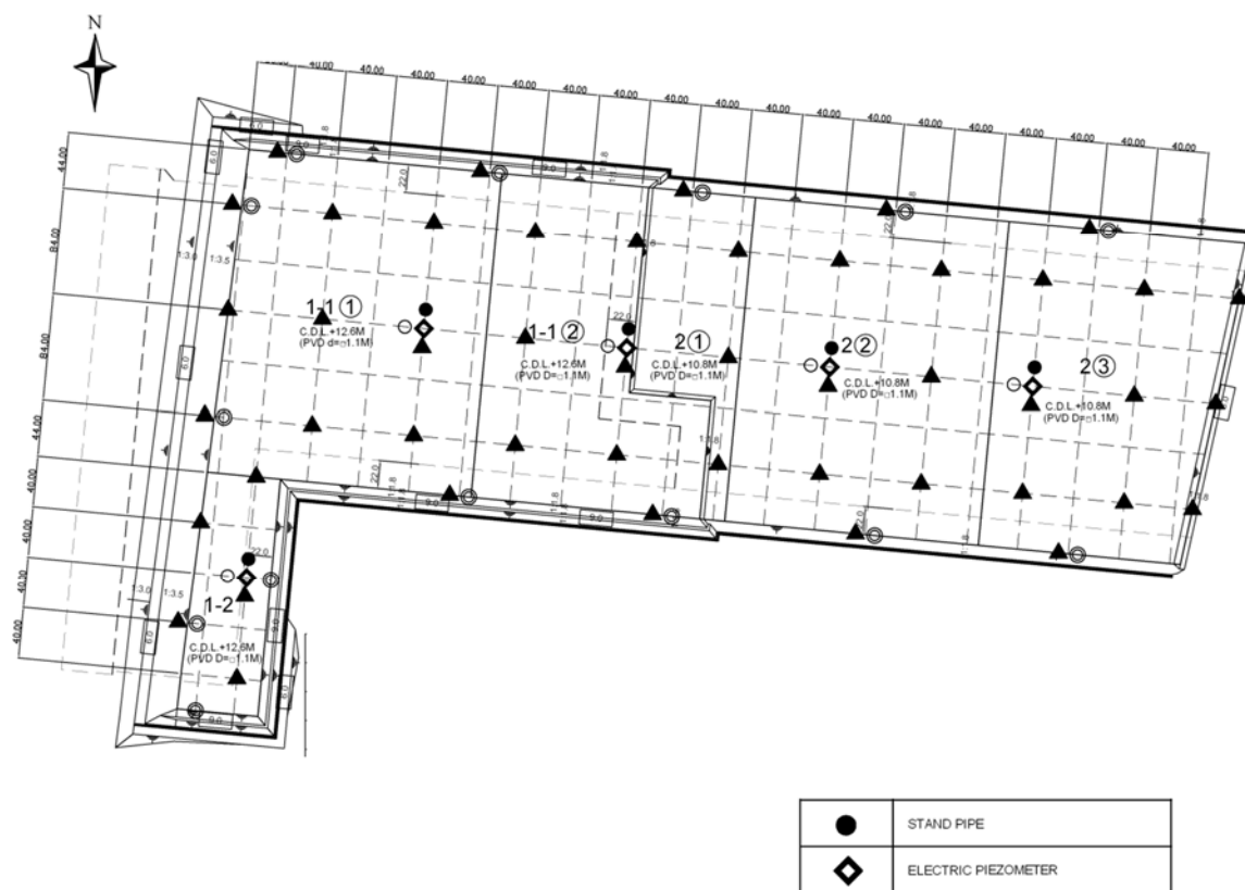
図 4.3-97 計測管理機器設置位置図
