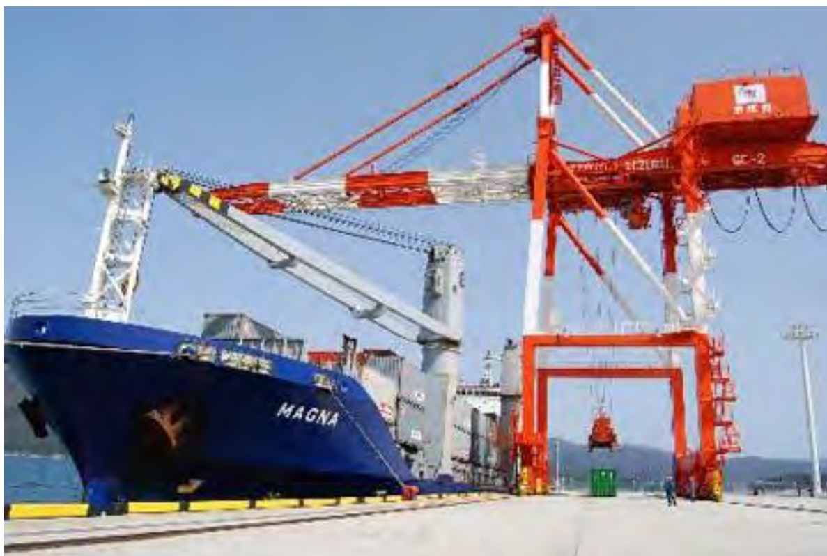
ガントリークレーン
