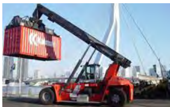
リーチスタッカー
