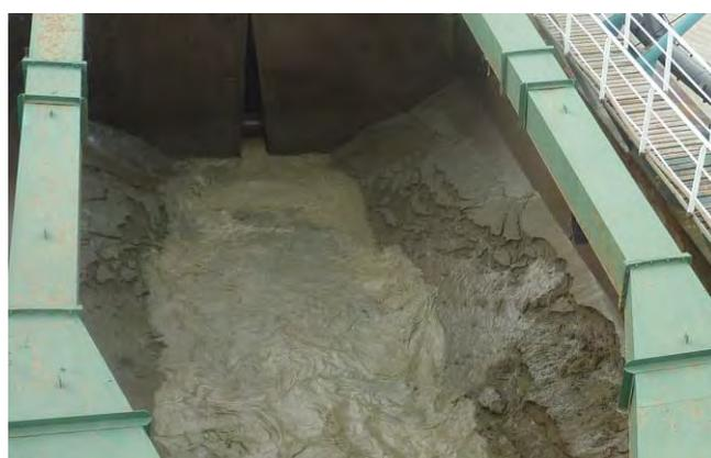
図 3.4-6 船底に付着した泥砂(ポンプ回転数 1,250R/M)
