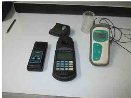
Toker浄水場 pHと濁度と残留塩素器 濁度と残塩の試薬がない。
