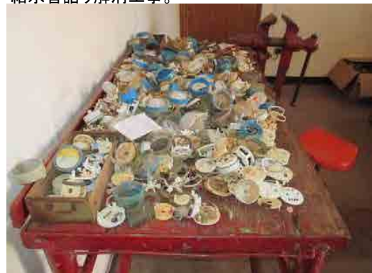
メーター修理 山積された故障メータ。
