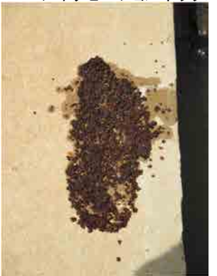
Mai Nefhi浄水場 アカズール型ろ過池 ろ床砂。
