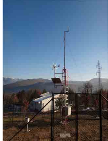
プロジェクトで設置した自動気象観測装置
