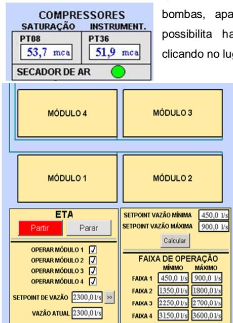
Feito isto deve-se simular uma vazão forçada, (fictícia) ao sistema, nesta mesma janela, para que os demais equipamentos sejam liberados para funcionamentos, o qual será mantida até ligar a primeira moto bomba na captação.
