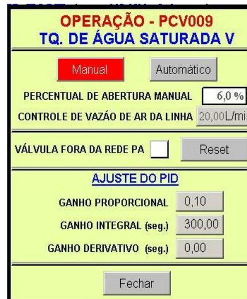
A mistura de ar/água é enviada aos filtros por pressão, a qual é controlada pelas válvulas " FBV" na entrada do filtro. Clicando sobre o ícone desta válvula, aparecerá a janela de comando:
