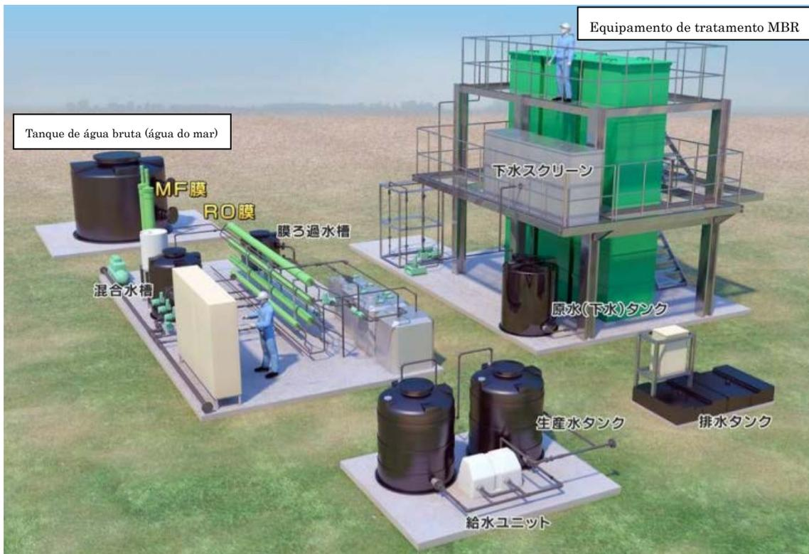
**Fig. 3 – Imagem do lay-out do exemplo de pesquisa para a execução do método de tratamento por lodo ativado com separação por membrana + osmose reversa.**
