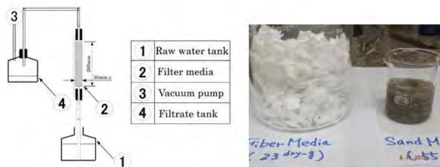
Figura 5.2-6 Instrumento e Meio de Filtração Experimentais
