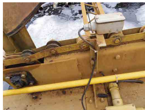
Sensores novos (após melhoria)
