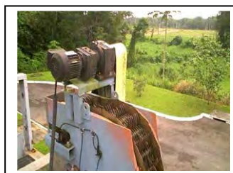
c. Morretes Removedor automático de detritos
