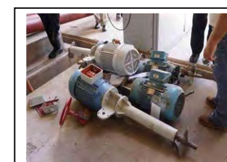
ap. Guaratuba Aerador
