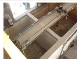
cv. Praia de Leste Misturador de lodo de saída de pequena quantidade
