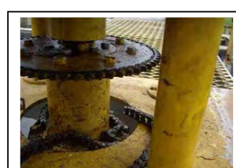
bg. Mecanismo do raspador de espuma do tanque de desaneração de Pontal do Paraná
