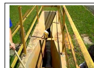
af. Sao Jorge Medidor ultrassônicos do nível de água
