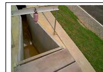
ao. Medidor ultrassônico de nível de Pontal do Paraná
