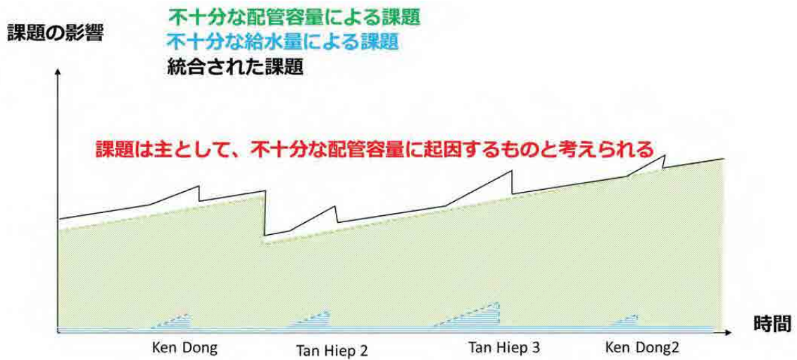
図 2-20. 配水場がない場合の Tan Hiep 系統の課題の推移<調査団作成>
