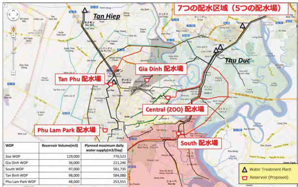
図 1-2. 先行 JICA 調査による配水場提案概要（5つの配水場）<調査団作成>
