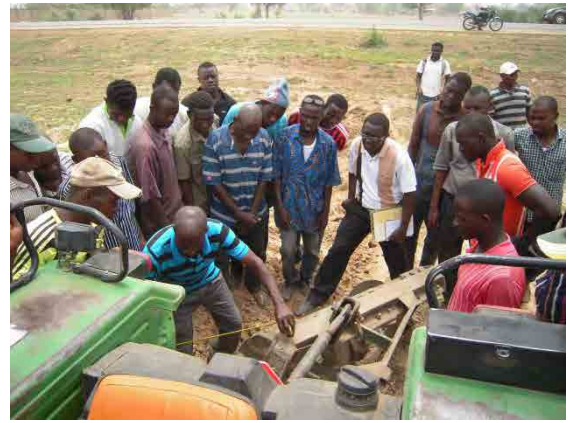
オペレーター研修：プラウの調整
