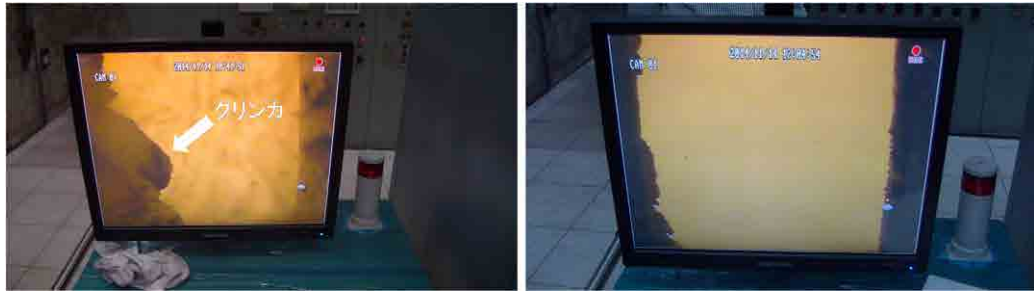
図 3-23 カメラ挿入孔の清掃（左：清掃前、右：清掃後）
