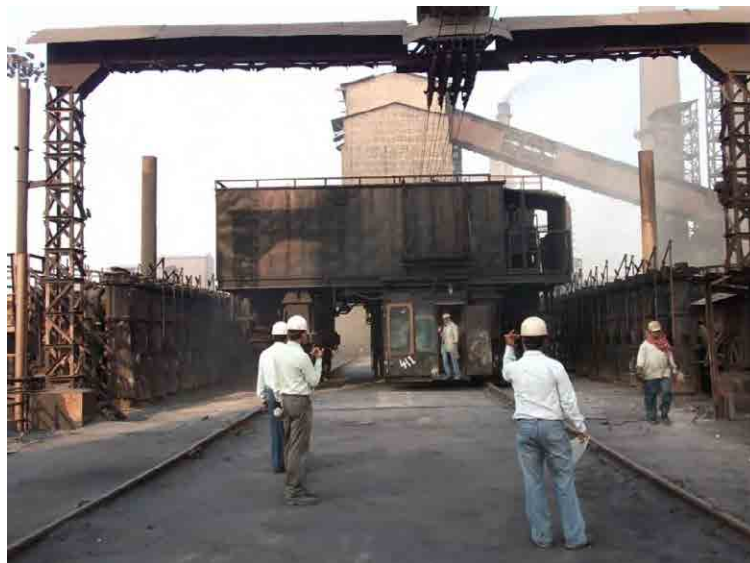
図 3-2 コークス炉屋上の装炭車と架空電線
