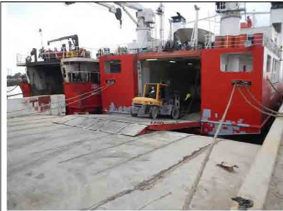
写真 1-7：オトワンガオフア号への積込状況 フォークリフトによりコンテナやバラ荷を搬入する。
