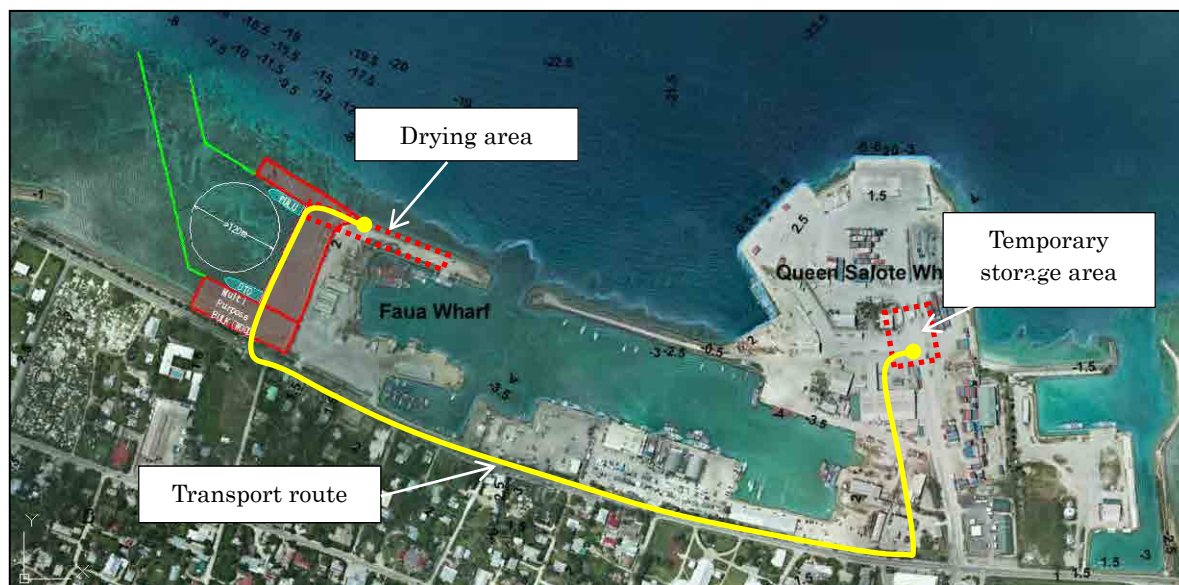
図 2-29 浚渫残土の取扱プロセス
