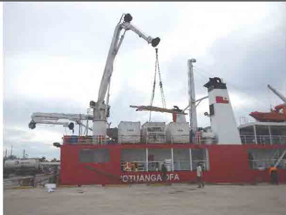
写真 1-9：船上クレーンによる積込状況 オトワンガオフア号の2台のクレーンによる荷役状況。
