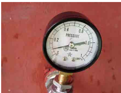
図 3-6 Amplas 地区の水圧調査 (0.8MPa)
