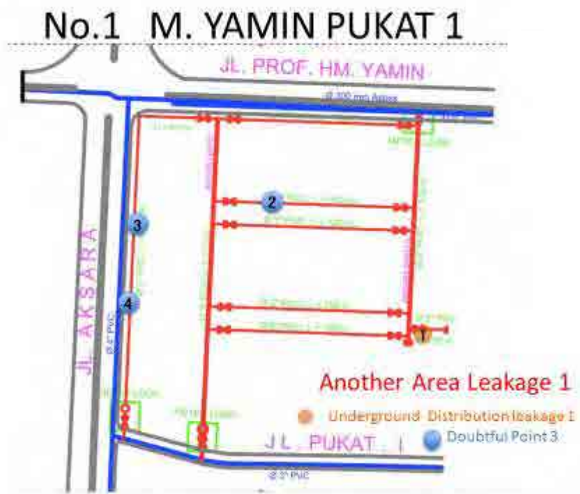
図 3-33 M.Yamin 支所 Pukat1 地区 漏水調査及び漏水地点
