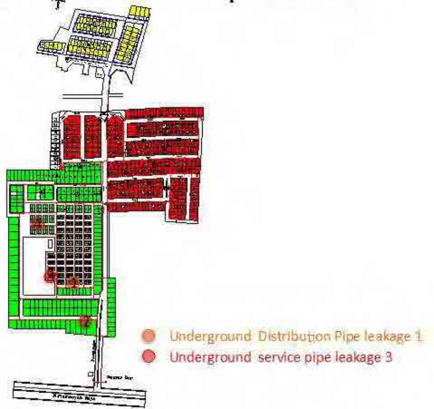
図 3-50 Sunggal 支社 Komp Waikiki 地区 漏水調査及び漏水地点
