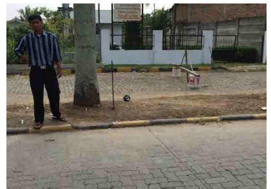
図 3-49 Waikiki 地区 音聴棒を利用して確実に接地
