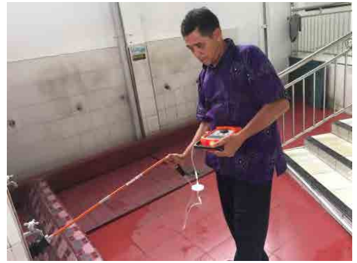
図 3-68 PDAM Tirtanadi 本局内モスクでのトレーサーガス式漏水調査 (左)蛇口にガス管設置 (右)PDAM Tirtanadi 職員による漏水箇所確認
