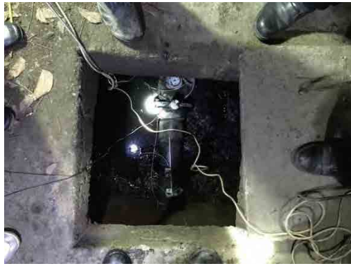
図 3-56 Bagan Deli 地区 夜間時調査 超音波流量計及び AS610 設置状況
