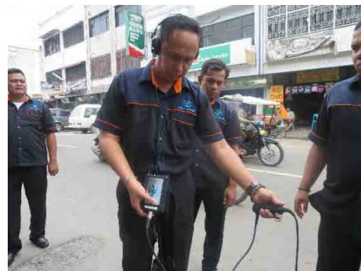
小型音聴式漏水探索器を使用した 地下漏水調査研修 (2014年9月15日)
