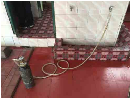
図 3-68 PDAM Tirtanadi 本局内モスクでのトレーサーガス式漏水調査 (左)蛇口にガス管設置 (右)PDAM Tirtanadi 職員による漏水箇所確認
