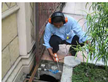
図 3-13 地上漏水調査(小型音聴式漏水探索・浅い埋設管での漏水)
