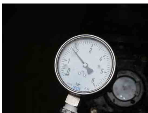
夜間最少流量計測時の水圧調査 (Denai 地区 2014年1月27日)
