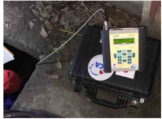
図 3-56 Bagan Deli 地区 夜間時調査 超音波流量計及び AS610 設置状況
