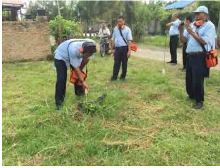
図 3-63 Komp Minimalis 地区 小型音聴式漏水探索機 ST04
