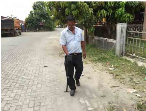
図 3-51 Waikiki 地区 D305 による配水管調査
