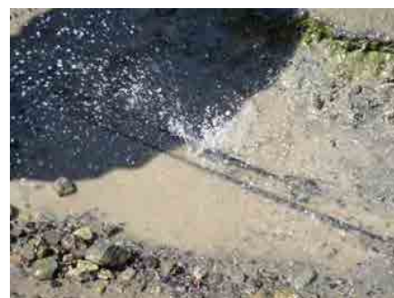
図 3-13 地上漏水調査(小型音聴式漏水探索・浅い埋設管での漏水)
