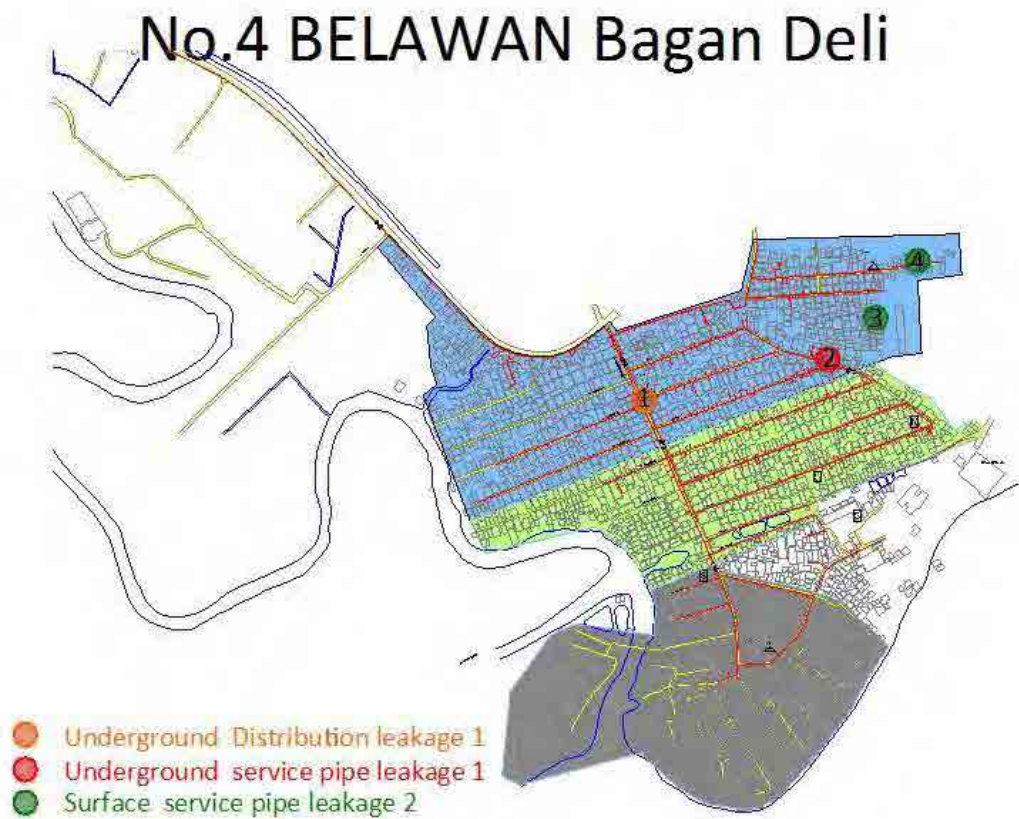
図 3-58 Belawan 支所 Bagan Deli 地区 漏水調査及び漏水地点
