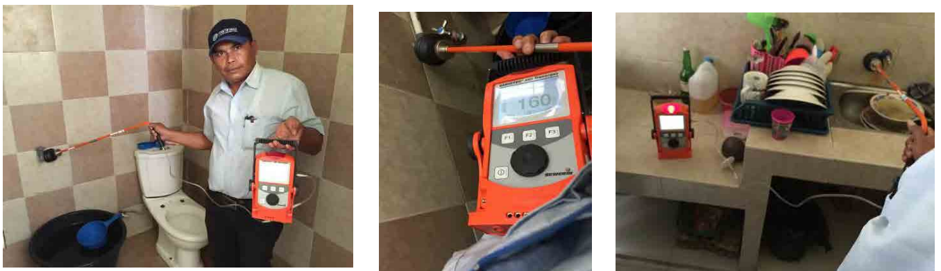
図 3-67 バリオテック 460 (左)漏水確認調査 (中央)検出数値 160 (右)台所にて検出
