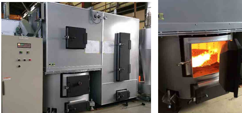
図 16 稼働試験状況 (バイオマスボイラー)
