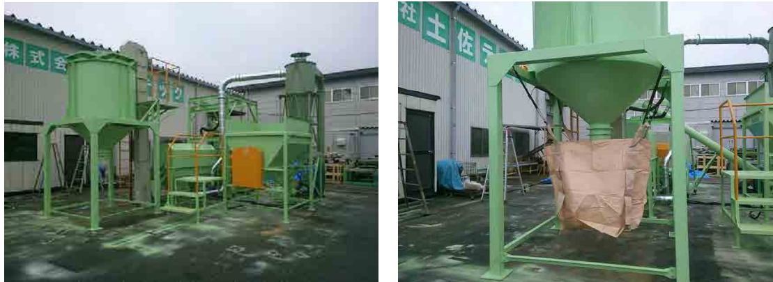
図 13 稼働試験状況 (左：ペレット造粒機全体図、右：ペレット排出口)
