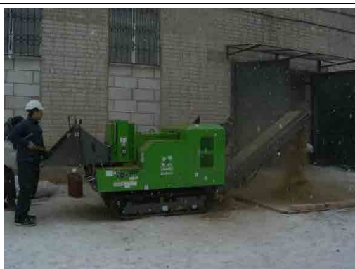
破砕機（ペレット製造装置システム）
