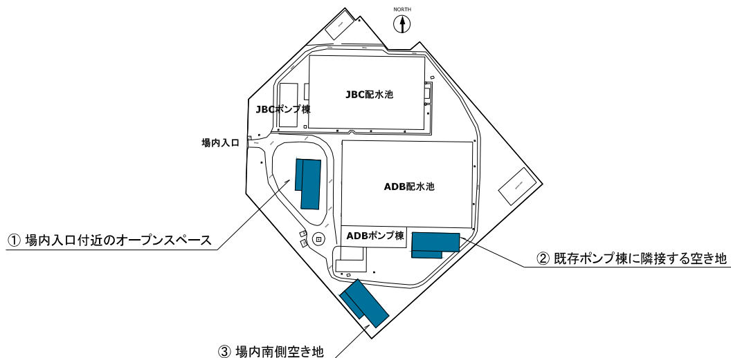
図 3.4 新ポンプ棟建設の候補地
