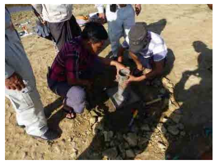
締め固め度確認試験（砂置換法）
