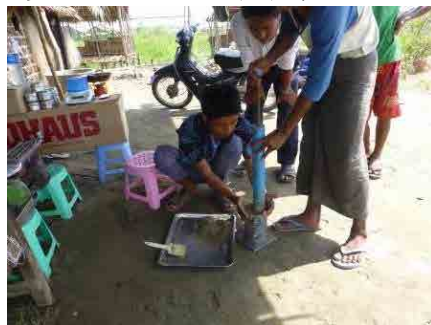
現地配合土の締め固め試験
