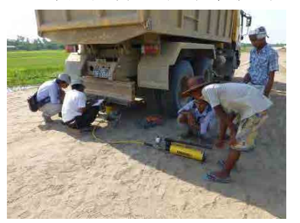
現場 CBR 試験（平板載荷試験）
