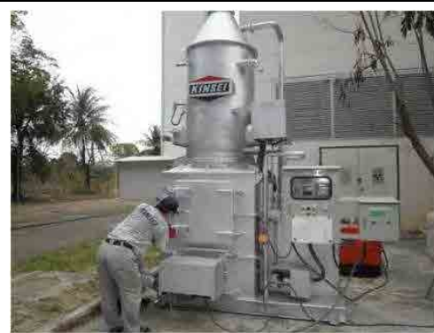
乾溜ガス化炉を密閉
