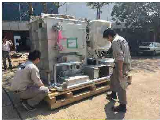
乾溜ガス化炉
