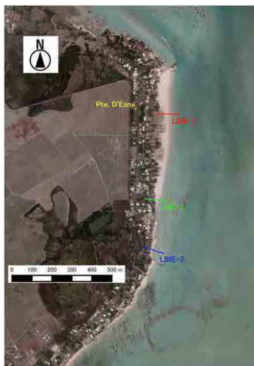
図 2.1.21 Pte. d'Esny における海浜断面測量位置
