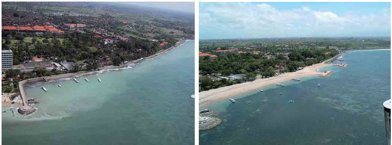
図 3.2.4 静的安定化工法 (例:インドネシアバリ海岸保全事業)
