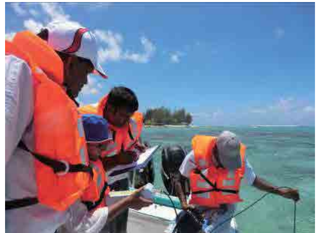
(項目1-5)多項目水質計による水質測定
