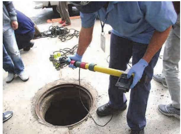
簡易カメラ（3台供与）竿の先に防水カメラを装着し、手元の画面で映像が見られる単純な構造のため、現地企業が類似品を開発し始めた。
