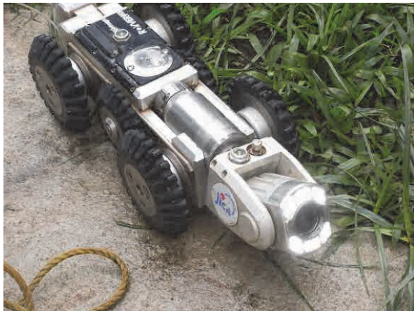
下水管路内を確認する自走式カメラ（1台供与）。カメラ部分が自由に動き、ズーム機能があるため、目的の場所の映像を得ることが可能。
