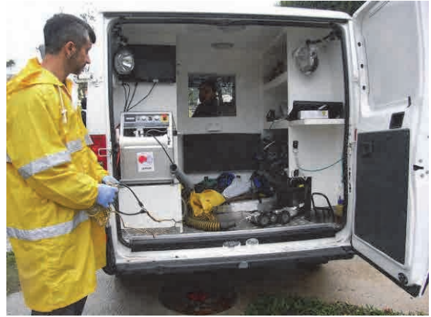
下水管路内診断用の TV カメラ搭載車（供与機材）。左上のモニターにて管路内の様子が確認でき、奥にはデータ解析用 PC を搭載。
