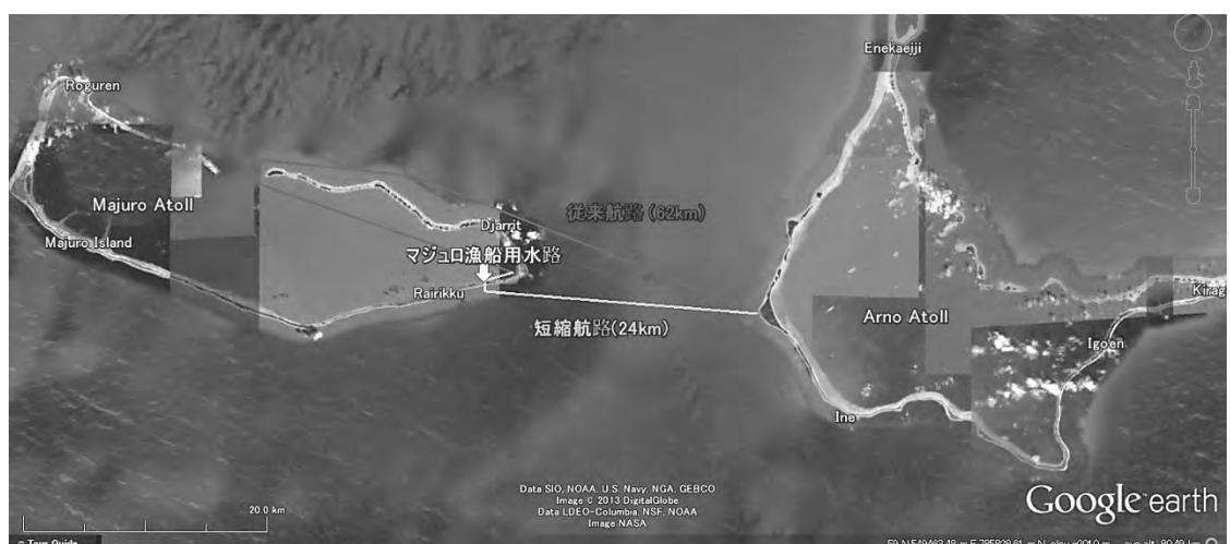
図 2-14 漁船用水路開削による航路の短縮効果
