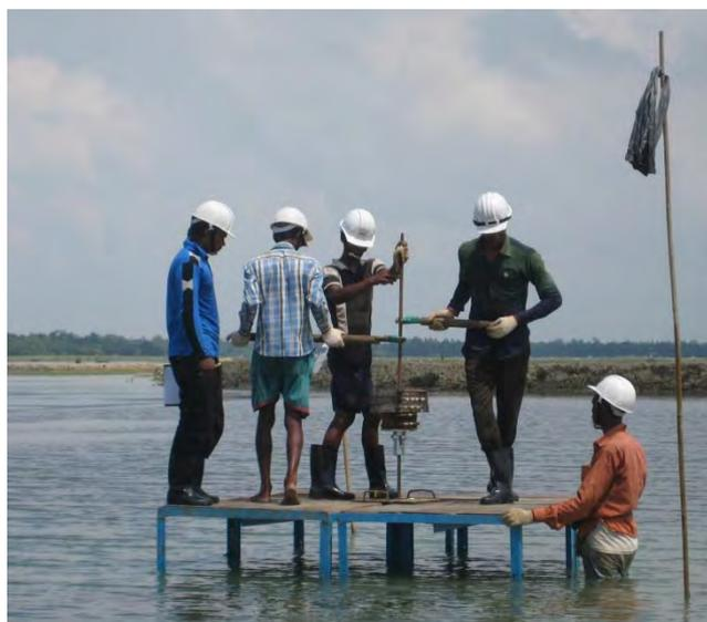
図 17.3-5 スウェーデン式サウンディング実施状況
