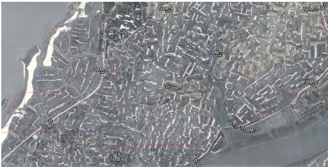
図 17.5-43 測量調査範囲と仮基準点の位置図
