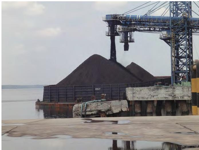
図 6.4-14 バージ船への積込み
