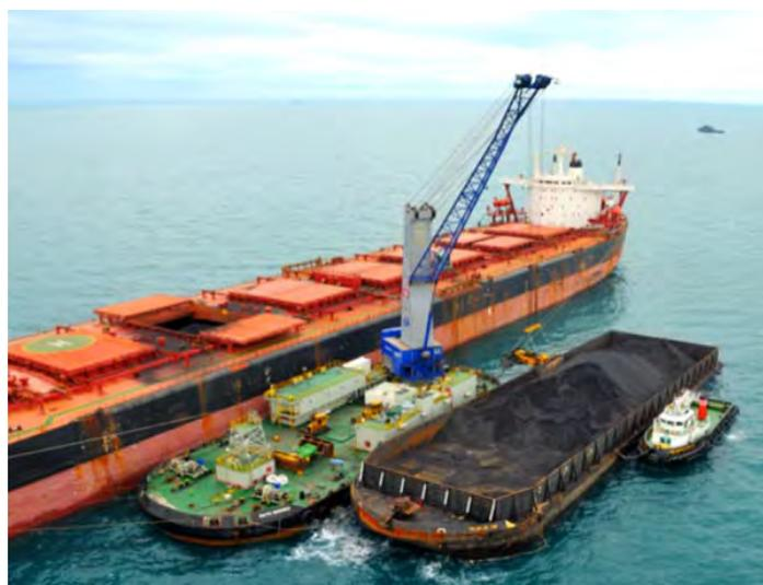
図 6.4-16 大型船への積込状況
