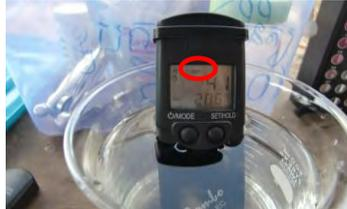
①pH/ECメーターの「MODE」スイッチを入れ、「SET/HOLD」ボタンを押して”ppm”の表示ができるようにする
