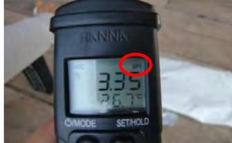
①pH/ECメーターの「MODE」スイッチを入れ、「SET/HOLD」ボタンを押して”pH”の表示ができるようにする
