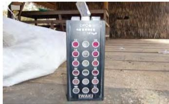
③専用の試薬(DPD試薬)1袋を測定装置の水に溶かす
