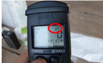
①pH/ECメーターの「MODE」スイッチを入れ、「SET/HOLD」ボタンを押して”µS”の表示ができるようにする
