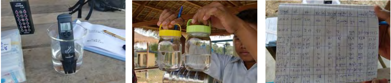
写真 2-3-15 水質検査の様子（左：pH/EC/TDS 計、中央：色、濁度の目視、右：記録ノート）
