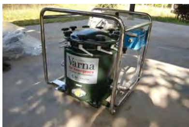
写真 2-3-13 災害時用の小型浄水装置
