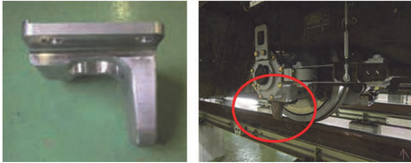
図 9.3-3 脱線防止ガイドと装着図
