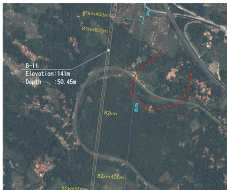
図 7.2-4 地すべりによる計画ルートへの検討 81 km付近（既存鉄道 111 km地点）
