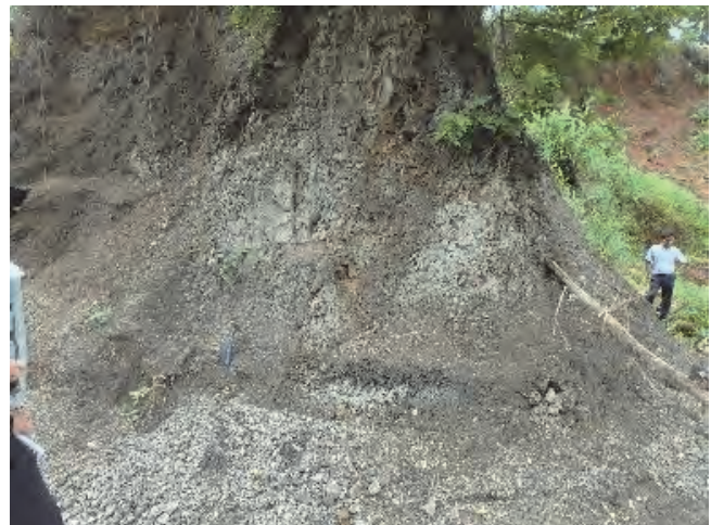
図 7.2-10 ジュティルフル層群泥岩のスレーキング状況
