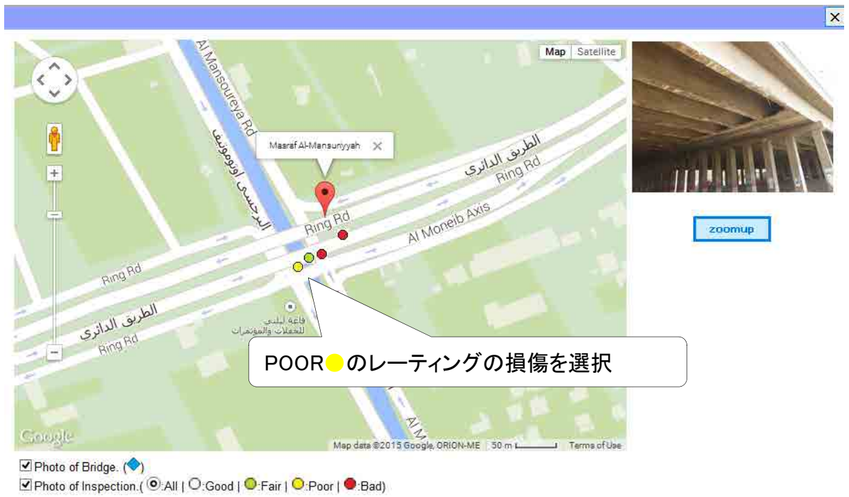
図 2-35 単一橋梁表示イメージ（複数損傷のポイント表示）
