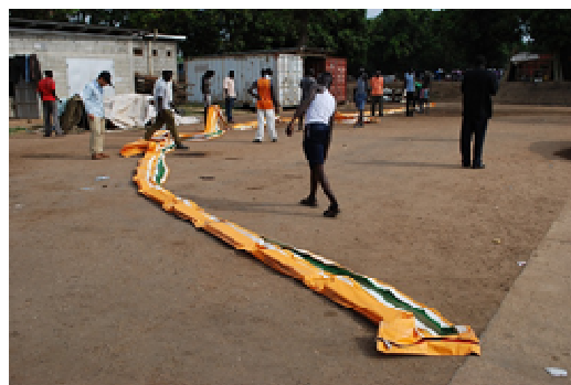
写真-2 オイルフェンスの用意
