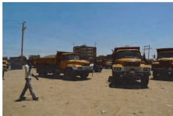
□骨材の調達トラック ハルツームから北遠方から運ばれるコンクリート用砂。質は問題ないが高価である。
