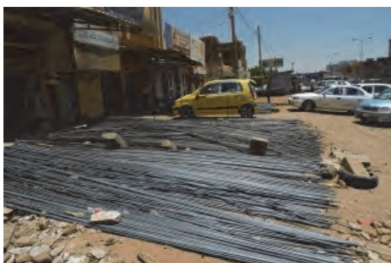
□鉄筋 BS規格品が中心で、中国製、トルコ製、ロシア製など原産地は様々である。建設材料は輸入に頼り、品質は様々である。
