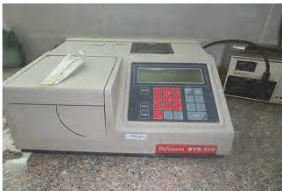
□生化学自動分析装置（アルバンジャデイド総合病院、ラボラトリー） 比較的最近の調達で状態は良い。妊婦の生化学検査にも用いる。
