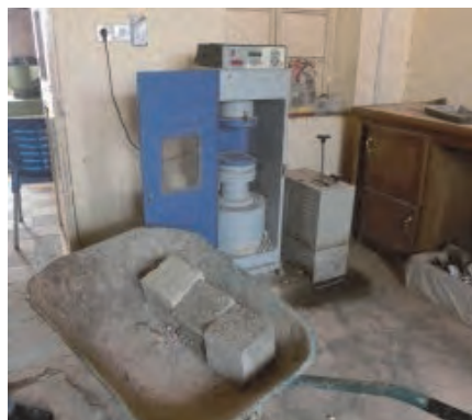
□コンクリート圧縮試験ラボの様子 民間の品質試験ラボ。ハルツームには大学をはじめ複数の試験ラボがある。規格はBS。
