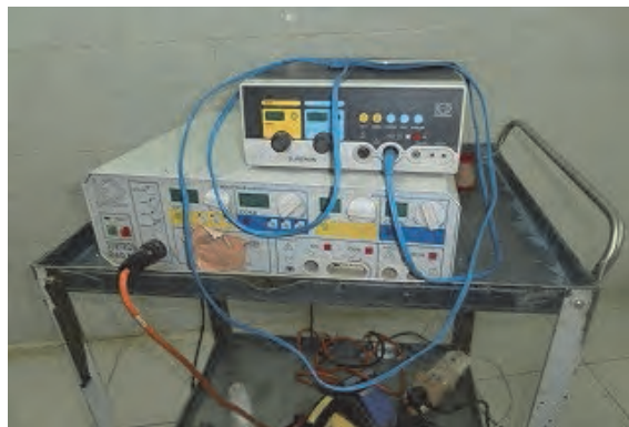
□電気メス（アルバンジャデイド総合病院、手術室） 帝王切開や外科手術の際に、切開や凝固に用いる。今後2-3年は十分に継続使用可能な状態である。
