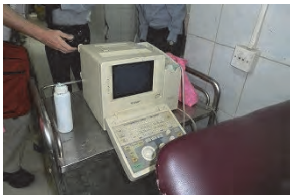
□超音波診断装置（アルバンジャデイド総合病院、陣痛室） モニターが小さいため診断が困難である。また、探触子にも亀裂が入っている。
