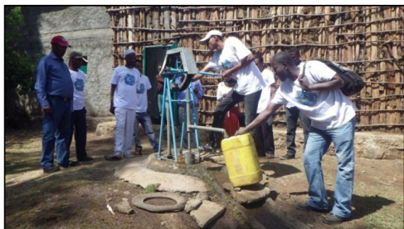
試験用に設置されたロープポンプ 撮影日：2015年2月13日 マスカン郡
