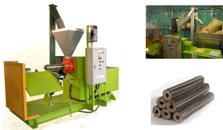
写真 3.1.1.1 トロムソ製グラインドミル(左：装置 右上：装置運転風景 右下：燃料)
