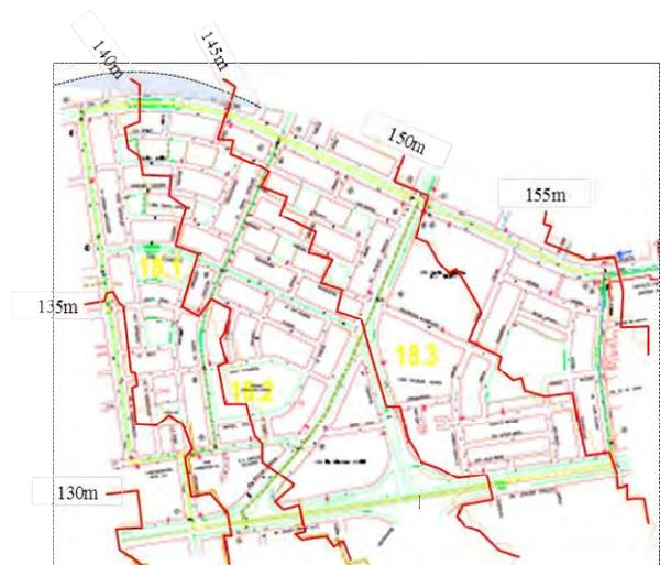
El Equipo de Expertos y la C/P hicieron la medición de presión en las 3 zonas, alta, media y baja del sector 18 de Breña. Se recopilaron datos de la presión de 24 horas del día y con esa medición se dio a conocer la variación diaria de la presión. Estos datos son importantes para el cálculo de la presión de todo el sector después de la medición del caudal mínimo nocturno con la utilización de la cámara que está en la zona media.
