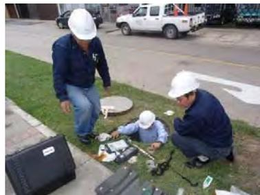
Configuración del caudalímetro
