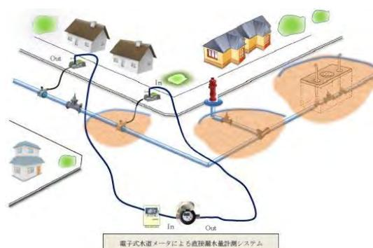
Figura 2.2.17 Método de medición de las fugas
