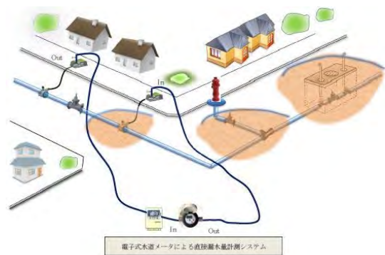
図2.2.17 漏水量測定の方法
